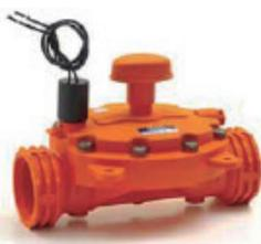
Serie **2211T**: Para funciones de apertura y cierre con solenoide 24VCA 2 vías y regulación manual. Para trabajar a presiones hasta 10 kg/cm<sup>2</sup>. Equipada con diafragma de 0,4 a 10 kg/cm<sup>2</sup>. Fabricada de nylon reforzado. Conexión rosca hembra BSP.
