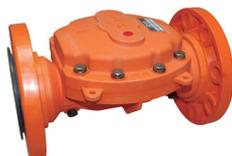
Serie **2033**: Para funciones de apertura y cierre y regulación de presión, caudal, etc. Para trabajar a presiones hasta 10 kg/cm<sup>2</sup>. Equipada con diafragma de 0,4 a 10 kg/cm<sup>2</sup>. Fabricada de nylon reforzado. Conexión brida normalizada PN16.
