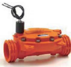
Serie **2211**: Para funciones de apertura y cierre con solenoide 24VCA 2 vías. Para trabajar a presiones hasta 10 kg/cm<sup>2</sup>. Equipada con diafragma de 0,4 a 10 kg/cm<sup>2</sup>. Fabricada de nylon reforzado. Conexión rosca hembra BSP.
