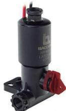
**Solenoid latch de tres vías/dos posiciones.** Paso 2,6 mm Ø. Cuerpo de plástico. Conexión 1/8". 2 hilos. Resistencia de 1ohm para programadores a pilas y de 4ohm para programadores a 12V (baterías). Con mando manual.
